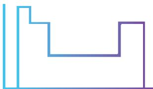
Intelligente Leuchentreiber werden bei Bedarf werkseitig mit komplexen Dimmprofilen programmiert. Bis zu 6 Kombinationen von Zeitintervallen und Lichtstärken sind möglich. Diese Funktion erfordert keine zusätzliche Verkabelung. Der Zeitraum zwischen Ein- und Ausschalten wird genutzt, um das voreingestellte Dimmprofil zu aktivieren.
